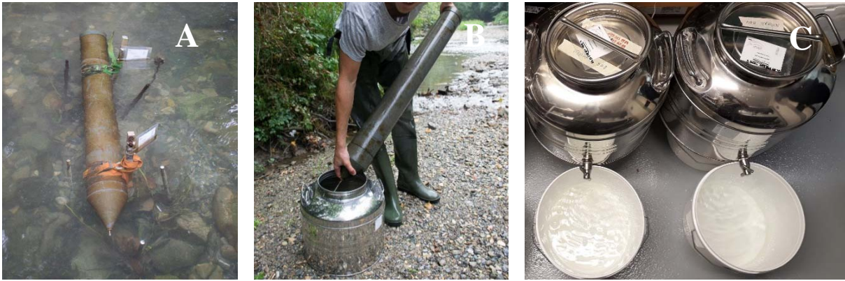
Figure 2 : (A) Trappe à matière en suspension (MES) fixée avec des lanières à deux socles (eux-mêmes maintenus par des tiges en métal dans le lit de la rivière) (B) Récupération du contenu d'une trappe (eau + MES) dans une cuve en acier inoxydable (C) Eau retirée après décantation des MES en chambre froide.
